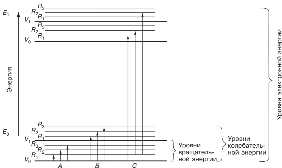
Рис. 16.3. Диаграмма энергетических уровней, иллюстрирующая изменения энергии при поглощении электромагнитного излучения: A — чисто вращательные переходы (дальняя ИК-область); B — вращательно-колебательные переходы (ближняя ИК-область); C — вращательно-колебательно-электронные переходы (видимая и УФ-области). E_0 — основное электронное состояние, E_1 — первое возбужденное электронное состояние
