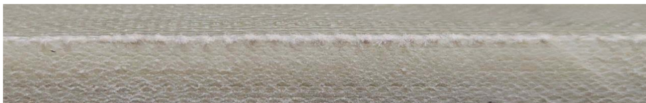
Рис. 1. Вид сбоку КМ на основе плазмообработанного СВМПЭ и эпоксидной смолы
