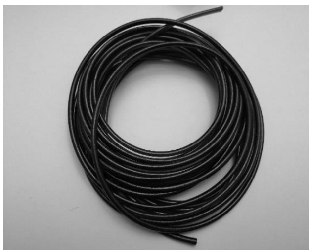
Рис. 3. Фото образцов композита экструдатов Ni/NiO/СЭО в виде стренг
