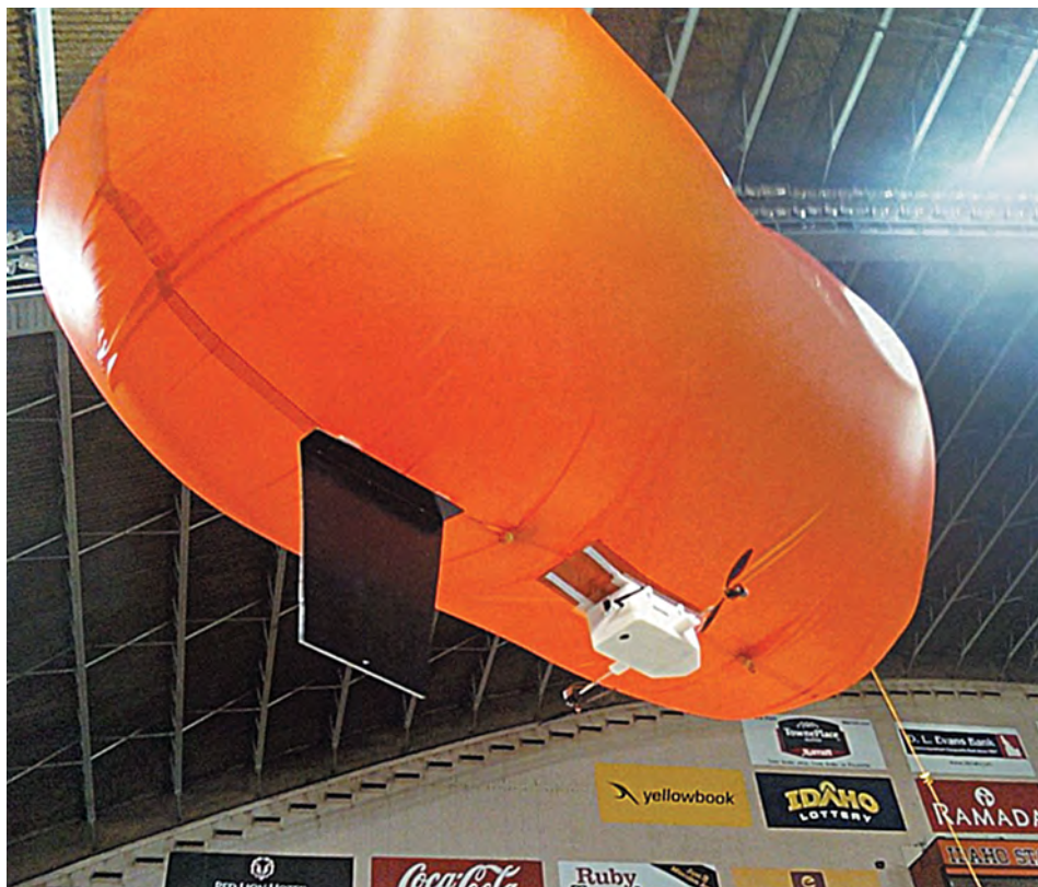
Рис. 2.5. Аэростат с гондолой, изготовленной на 3D-принтере (предоставлено Geran Call)
