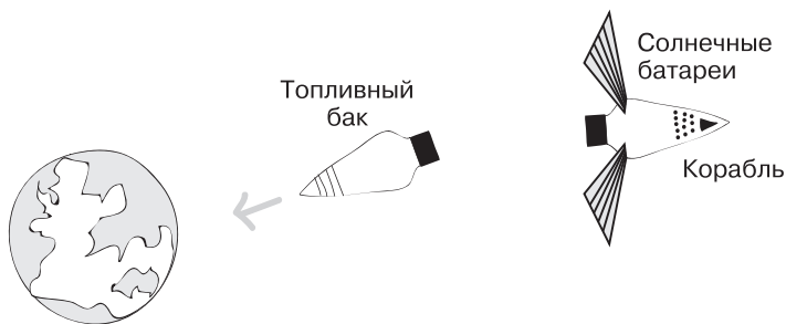
5. Топливный бак возвращается на Землю. Космический корабль разворачивает солнечные батареи и отправляется к Марсу
