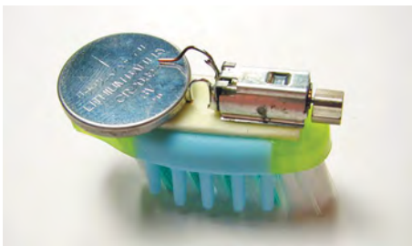
Рис. 1.7. Bristlebot — самый простой из существующих роботов (предоставлено Windell H. Oskay, www.evilmadscientist.com )
